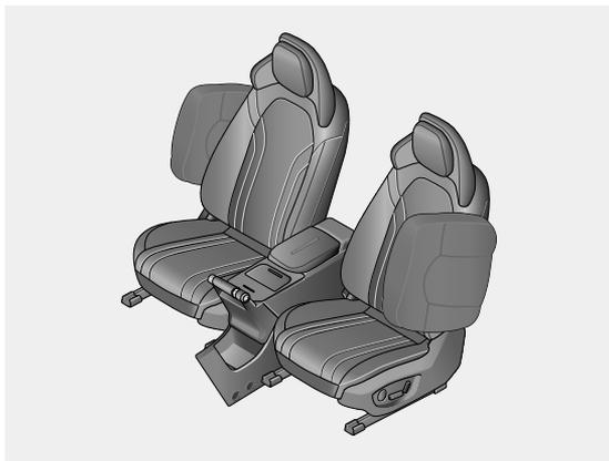
侧面安全气囊安装在前排座椅靠背侧面，其安装位置上标有“**AIRBAG**”字样。在较严重的侧面碰撞事故中，可以对乘员的整个上身（胸部、腹部和胯部）提供额外的保护。
