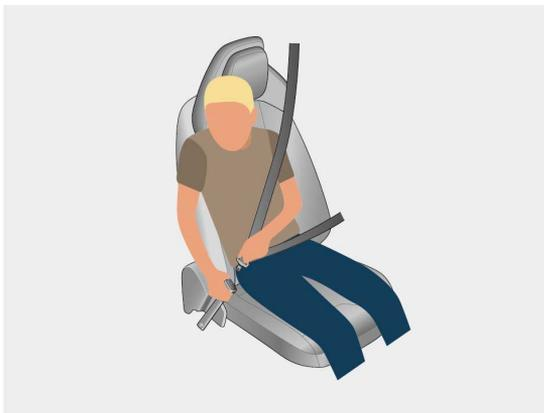
1. 调整座椅座垫、座椅靠背至合适的乘坐位置；拉动侧面饰板上部的金属舌片，将安全带拉出适当长度，从肩膀上部斜挎过前胸，确保一侧肩部和手臂处在肩带与胯带之间，将金属舌片按入身体另一侧的安全带锁扣中，听到“咔嗒”声后，即表明安全带被锁止；
