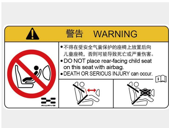
**警告:** 不得在受安全气囊保护的座椅上放置后向儿童座椅，否则可能导致死亡或严重伤害。
