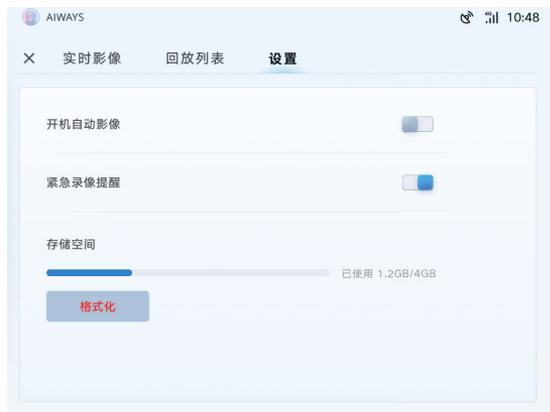
开机自动影像：车机开启后行车记录仪自动开启一般录像，并循环录制，每录制 5 分钟生成一个文件进行保存。
