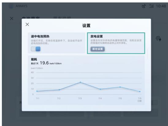
此外您也可以通过车辆设置进入外部设备供电界面，对外部设备供电进行设置。
